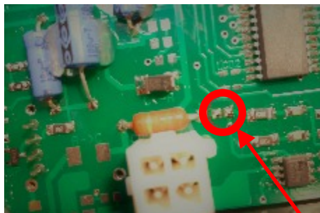
Après suppression du pont de soudure Configuration d'origine avec le pont de soudure
